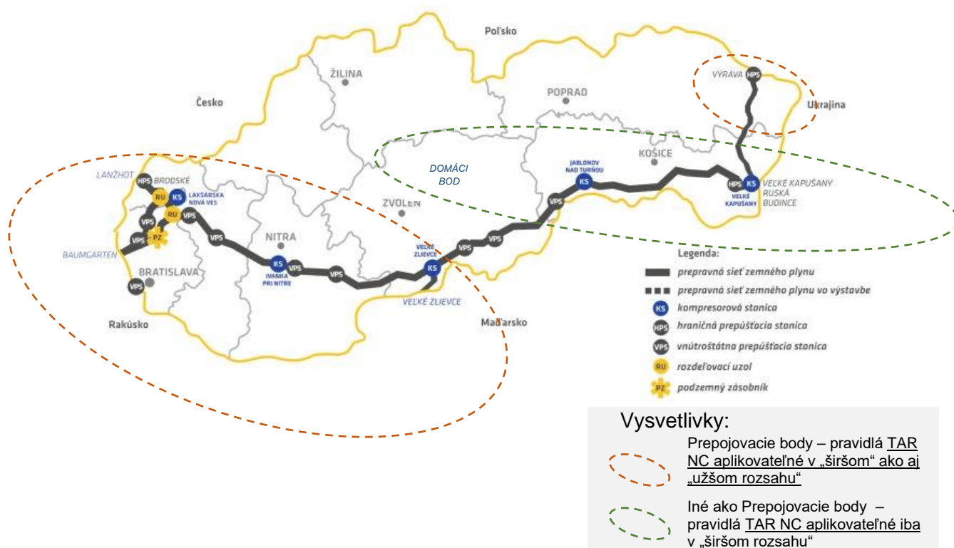
Obrázok 1: Schéma prepravnej siete zemného plynu Slovenskej republiky. Pozn.: obrázok obsahuje aj kompresorovú stanicu č.2, ktorá sa momentálne nevyužíva pre potreby zvyšovania tlakovej úrovne prepravnej siete a v majetku spoločnosti sa nachádzajú len jej súčasti, ktoré sú nevyhnutné pre prepravu plynu.
