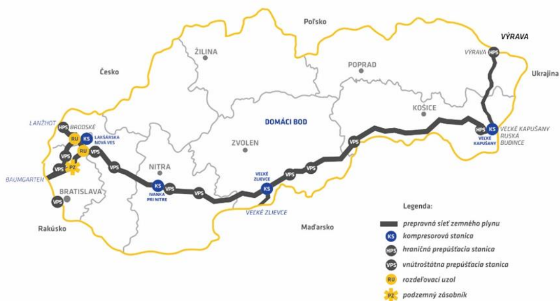
Obrázok 2: Štrukturálne znázornenie slovenskej prepravnej siete zemného plynu v primeranej úrovni detailu.
