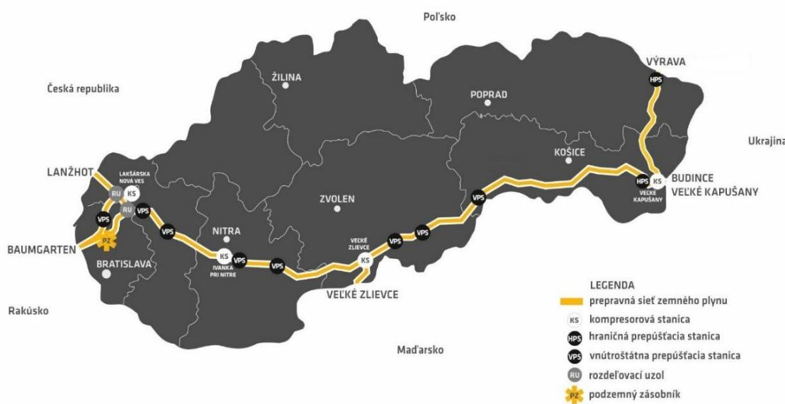
Obrázok č. 2: Prepravný systém prevádzkovaný spoločnosťou Eustream<sup>1</sup>
